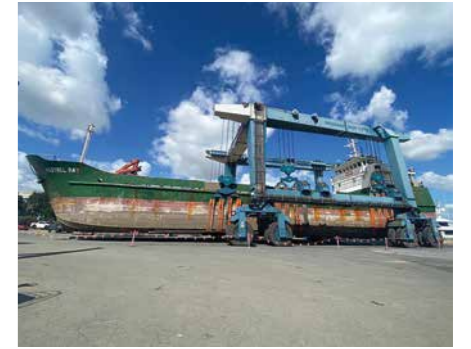
Anwendung: Arbeitsschiff mit Travellift
