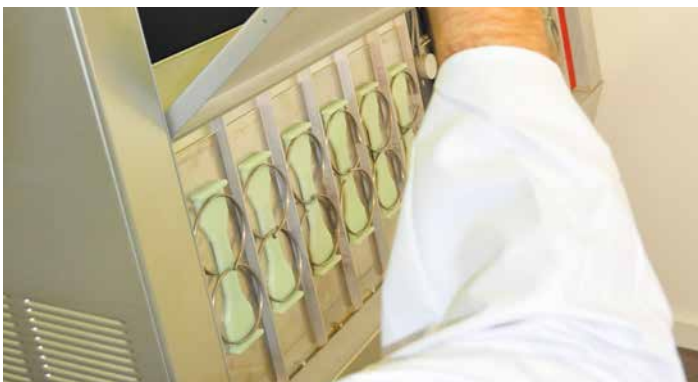
Weather-Tester zum Testen der Kunststoffe in Kombination mit Licht, Wärme und Luftfeuchtigkeit
