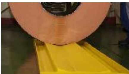
Tappetino da bobina con vaschetta di raccolta dell'olio circonferenziale
