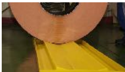
Tapis à bobines avec bac de récupération d'huile sur le pourtour
